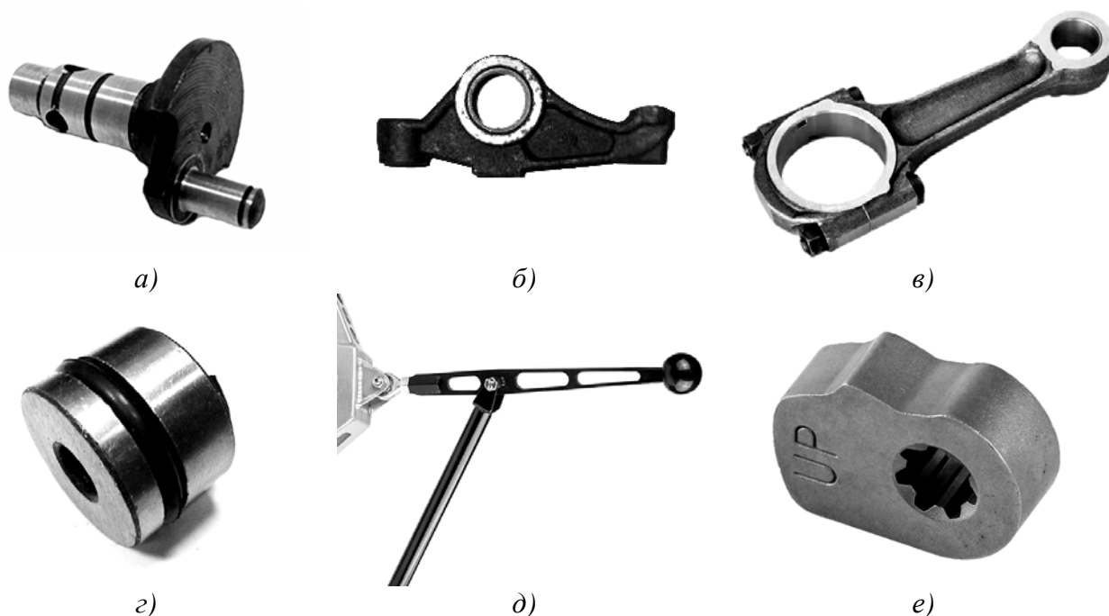
Рисунок 1.2 – Ланки механізмів, аркуш 1: а – кривошип; б – коромисло; в – шатун; г – повзун; д – куліса; е – кулачок
