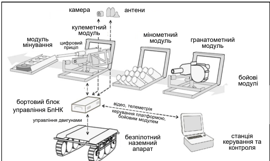
Рисунок 5 – Типовий склад безпілотного наземного комплексу
