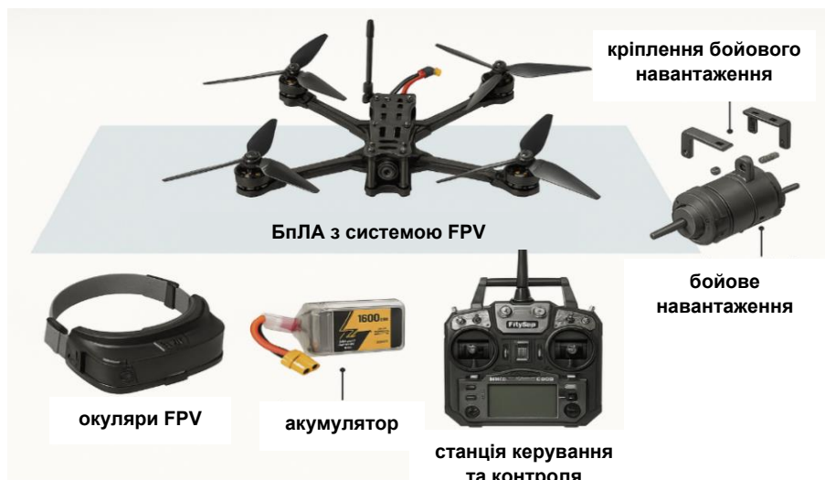
Рисунок 1 – Типовий склад мультикоптерного БпАК(С) з системою FPV
