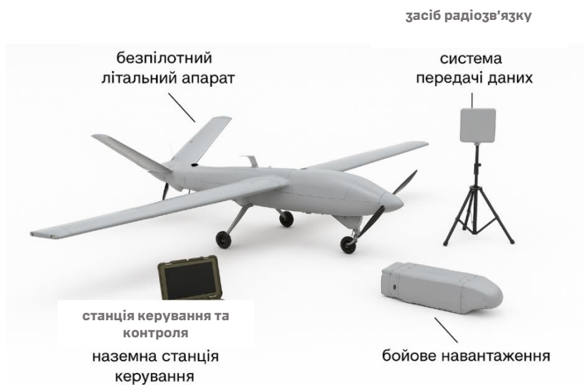
Рисунок 3 – Типовий склад БпАК(С) літакового типу
