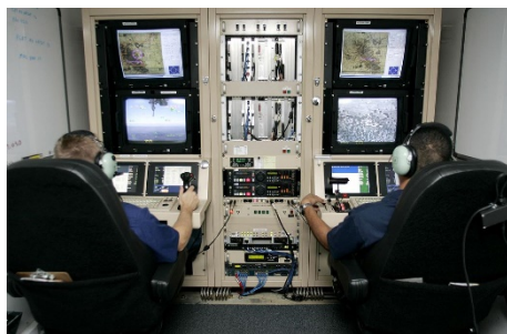
Наземний пункт керування безпілотним літальним апаратом. Екіпаж виконує бойовий (спостережний) політ над територією. Ліворуч – пілот, праворуч – оператор сенсорів
