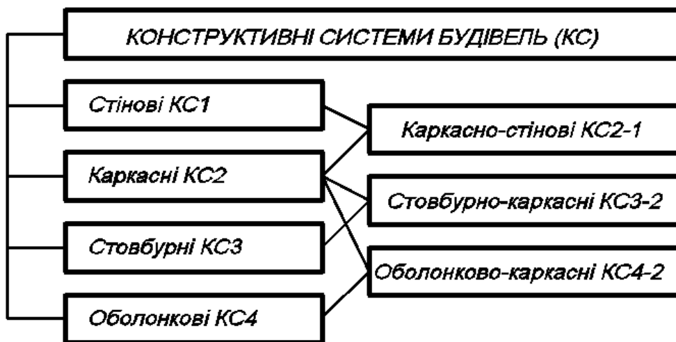
Рис. 1.2. Класифікація будівель за конструктивними системами.
