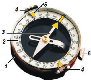
Рис. 1.2. Компас Адріанова: 1 - корпус; 2 - шкала (лімба); 3 - магнітна стрілка; 4 - візирний пристрій (мушка і цілик); 5 – показчик відліків; 6 - гальмо
