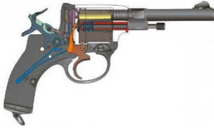
Рис. № 2. Основні вузли, деталі та механізми револьвера Наган 1895: ствол; рамка; шомпольна трубка; шомпол; спускова скоба; барабан; рухома трубка; пружина трубки; вісь барабана; казенник; повзун; спусковий гачок; курок; шатун; собачка; бойова пружина; бойок.
