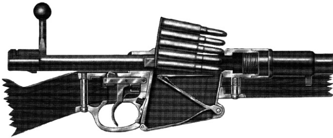
Рис. № 3. Основні вузли, деталі та механізми гвинтівки Маузер 1889: ствол зі ствольною коробкою; затвор із замикальним механізмом й ударним механізмом; спусковий механізм; зупин затвора (затримка затвора); відбивач; патронна коробка зі спусковою скобою; механізм подавання патронів; прицільні пристрої; ложе зі ствольною накладкою.
