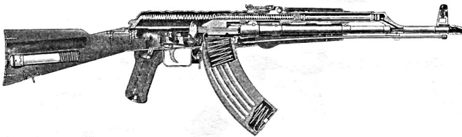
Рис. № 4. Основні вузли, деталі та механізми автомата АКМ: ствол із ствольною коробкою, прицільним пристосуванням і прикладом; компенсатор; кришка ствольної коробки; затворна рама з газовим поршнем; затвор; зворотний механізм; газова трубка зі ствольною накладкою; ударно-спусковий механізм; цівка; магазин.
